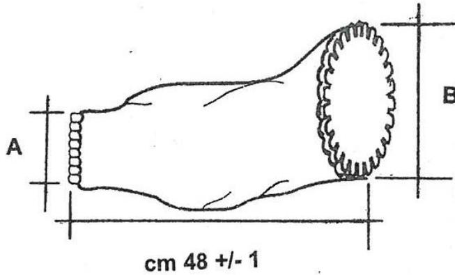
A = 7,5 cm +/- 1 diamètre à repos (en tension 15 cm +/- 1)
