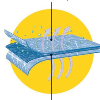
**Couches intermédiaires** – Microfibres en réseau serré qui filtrent de nombreuses solutions aqueuses et particules sèches
